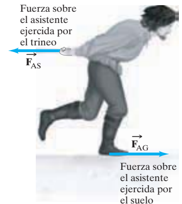
FIGURA 4-13 Ejemplo 4-5. Las fuerzas horizontales sobre el asistente.
