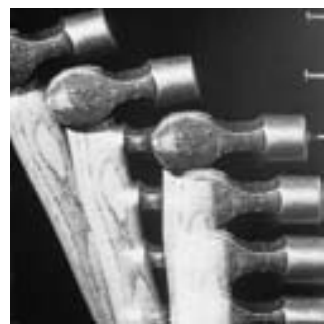
FIGURA 4-7 Un martillo que golpea un clavo. El martillo ejerce una fuerza sobre el clavo y el clavo ejerce una fuerza contraria sobre el martillo. Esta última fuerza desacelera el martillo y lo lleva al reposo.
