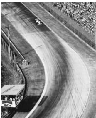
FIGURA 5-22 Automóvil de carreras que se dirige hacia una curva. Por las marcas de los neumáticos en el pavimento, vemos que la mayoría de los autos de carreras experimentan una fuerza de fricción suficiente para darles la aceleración centrípeta necesaria y tomar la curva con seguridad. Pero también vemos unas cuantas marcas de neumáticos de autos sobre los cuales no actuó suficiente fuerza, y que desafortunadamente siguieron trayectorias casi rectas.
