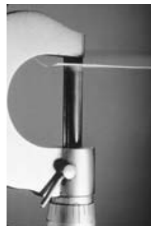
FIGURA 1-8 Ejemplo 1-6. Micrómetro usado para medir espesores pequeños.
