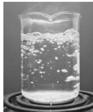
FIGURA 18-8 Ebullición: burbujas de vapor de agua flotan hacia arriba desde el fondo (donde la temperatura es más elevada).
